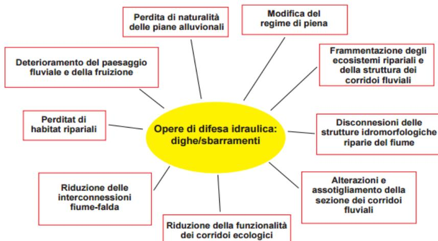
Figura 17. Schema degli effetti derivanti dalle opere di difesa idraulica (da EU CIS, 2006).
